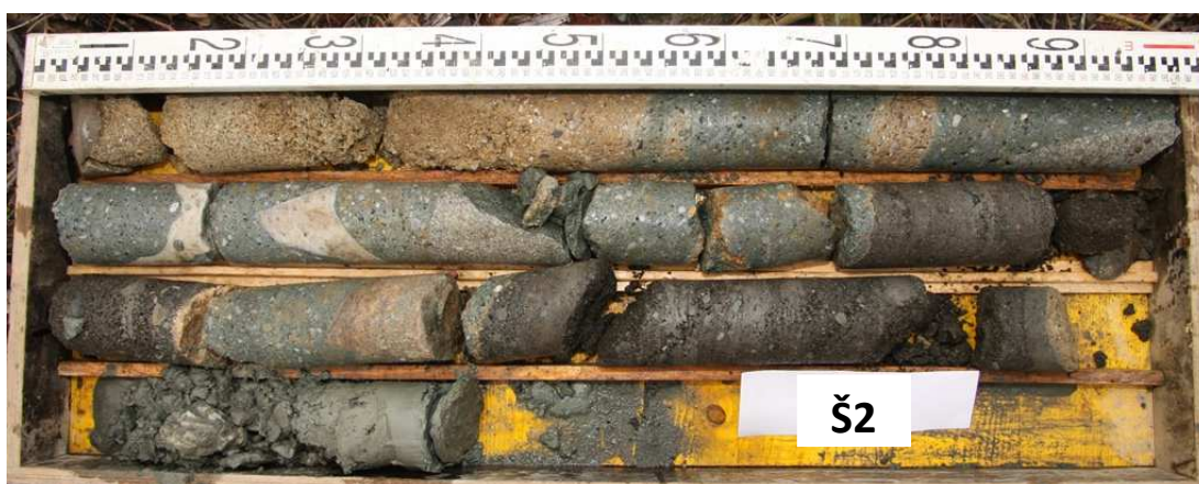
Obr. č. 4 - diagnostický vrt Š2 - pod úroveň základové spáry opěry Uničov
