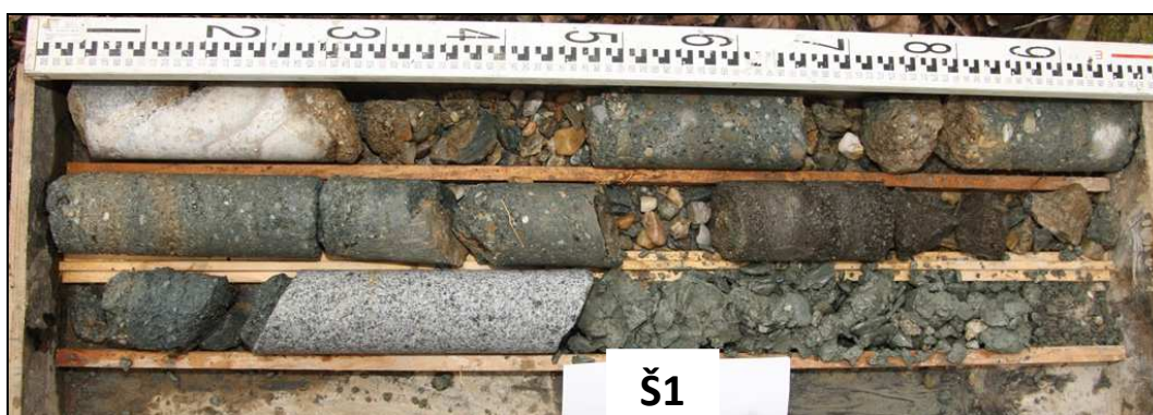
Obr. č. 3 - diagnostický vrt Š1 - pod úroveň základové spáry opěry Olomouc
