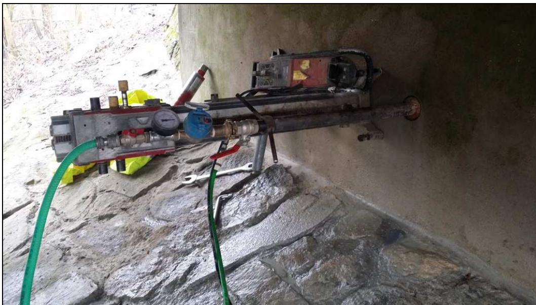
Obr. č. 7 – provádění vodní tlakové zkoušky ve vrtu V2 - opěra Uničov
