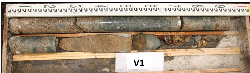
Obr. č. 1 - diagnostický vrt V1 - za rub opěry Olomouc
